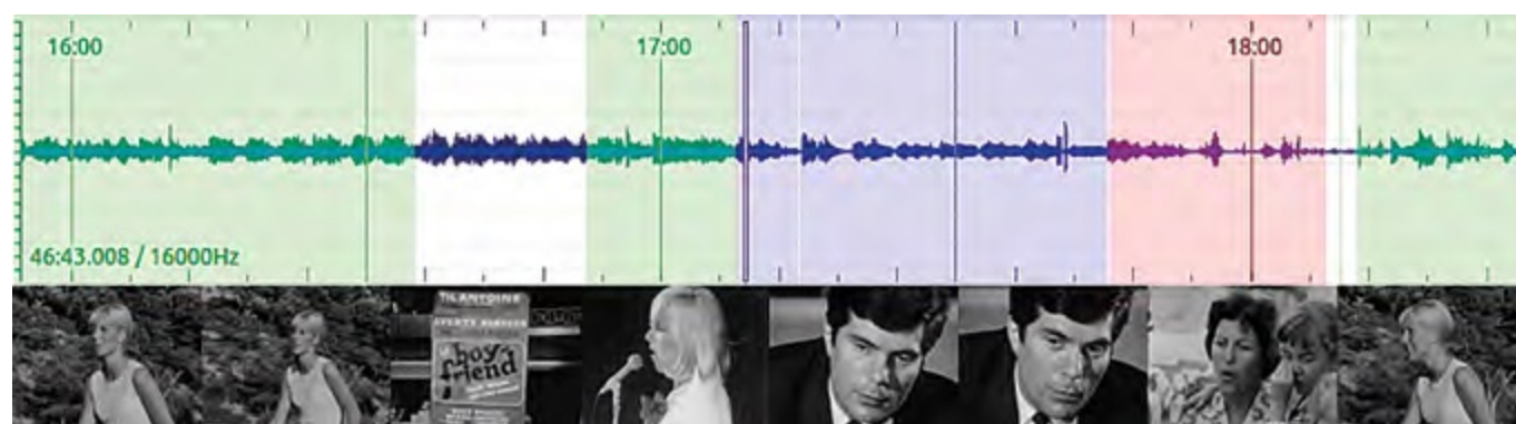
Figure 1 – Exemple de diarization : les instants des prises de parole des différentes personnes sont détectés automatiquement grâce à l'analyse du signal audio. L'opérateur humain identifie ensuite quels segments correspondent à la personne ciblée.
